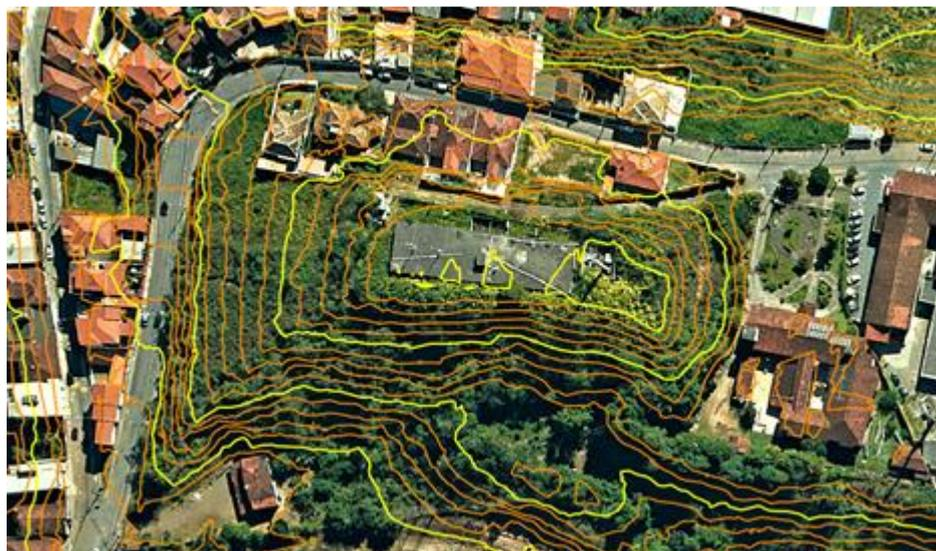
Figura 2: Imagem geral, com curvas de nível, capturada no Topocart.
